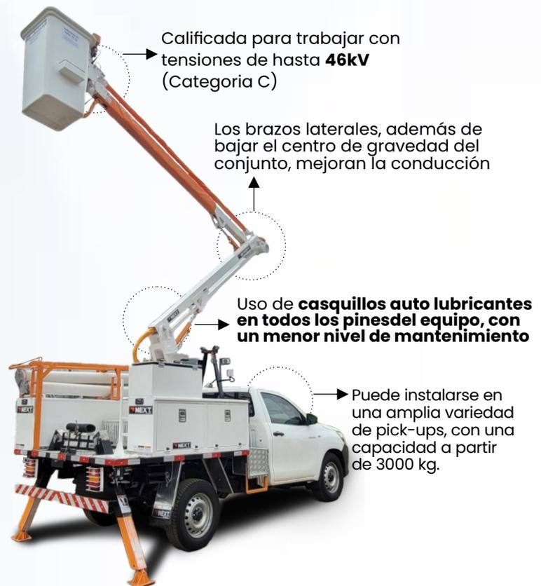
\*El equipo puede accionarse mediante un sistema eléctrico, electrohidráulico o hidráulico. Uso de cada tipo de instalación que debe analizarse en función del perfil operativo y el vehículo elegidos por el cliente.\*
