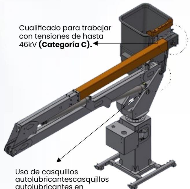
Uso de casquillos autolubricantes en todos los puntos del equipo, acelera el mantenimiento preventivo.
